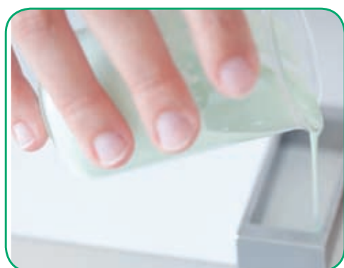
Рис. 3. Заполнение аппликатора для отливки пленки.
