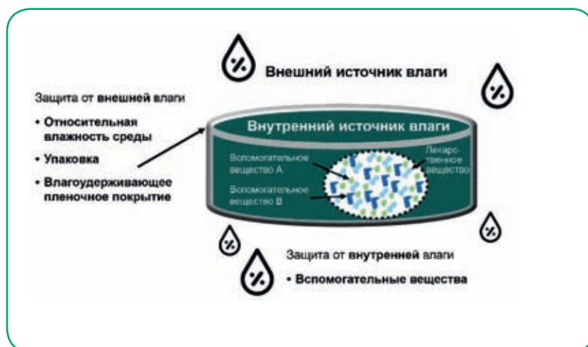
Рис. 1. Подходы к защите от внешней и внутренней влаги.
