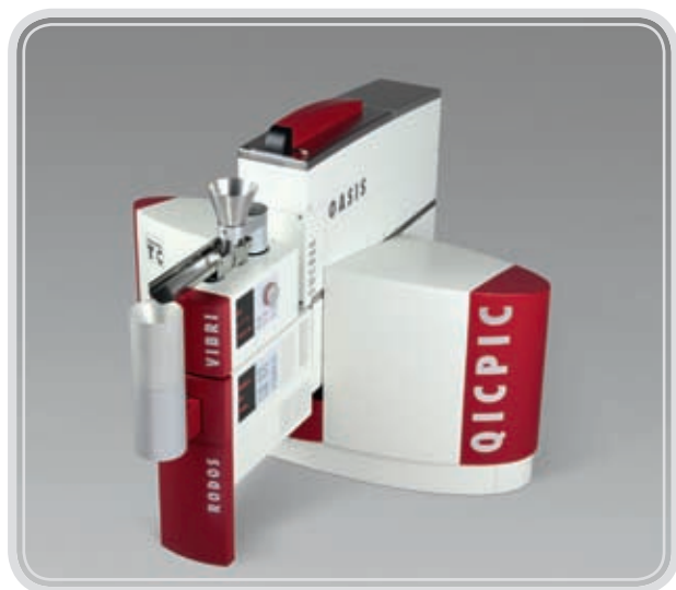
Рис.6. Динамический анализатор изображений QICPIC с комбинированной системой диспергирования порошковых и жидкостных продуктов OASIS (источник: Sympatec GmbH).
