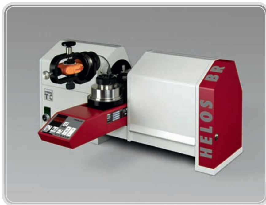
Рис. 1. Лазерный дифракционный гранулометр HELOS с адаптивной системой INHALER (источник: Sympatec GmbH).
