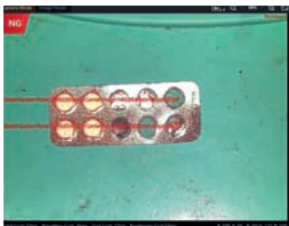
Рис. 3. Система контроля качества для блистерной машины на основе смарт камеры под управлением ПО от Медтех ТД.
