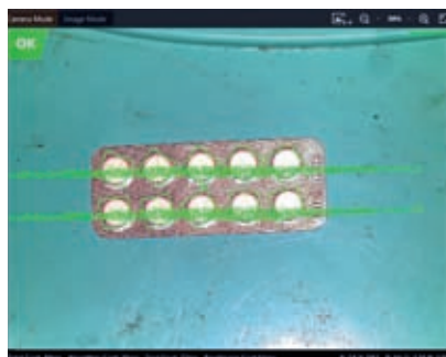
Рис. 3. Система контроля качества для блистерной машины на основе смарт камеры под управлением ПО от Медтех ТД.
