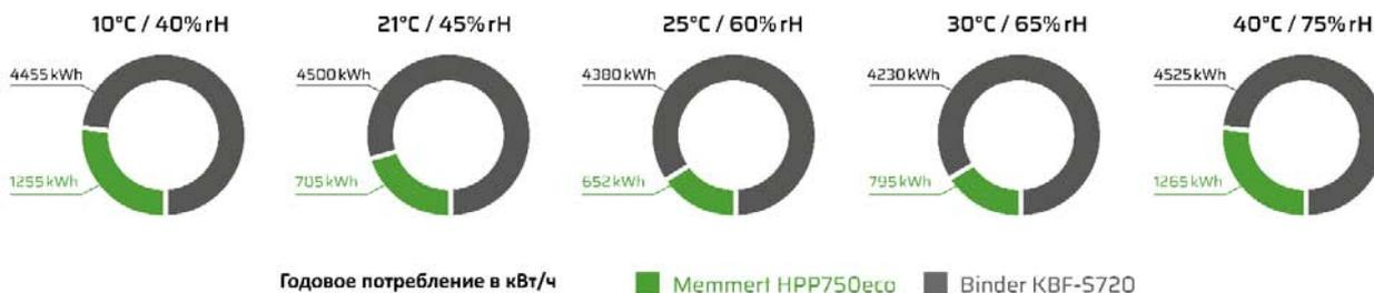
тана для создания эффективной альтернативы компрессорам. Климатическая камера HPPeco, а также охлаждающий Пельтье инкубатор IPPeco потребляют всего одну седьмую часть энергии по сравнению с компрессорным оборудованием конкурентов.
