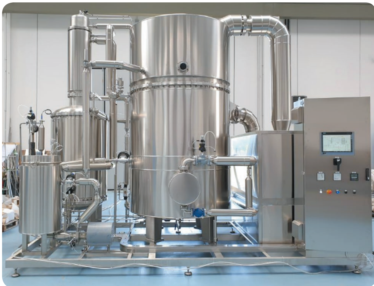
Рисунок 6. Термокомпрессор с электрическим приводом (GDN BWT Pharma & Biotech, 2023).
