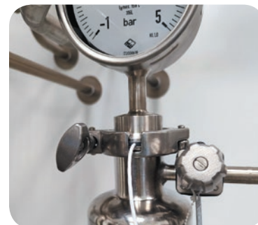
Размещение температурного датчика внутри фильтродержателя через специальную прокладку
