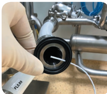
Размещение температурного датчика внутри трубопровода через специальную прокладку
