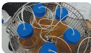
Установка датчиков внутрь флаконов при квалификации парового стерилизатора
