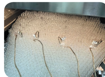
Контроль распределения температуры в зонах депирогенизационного туннеля
