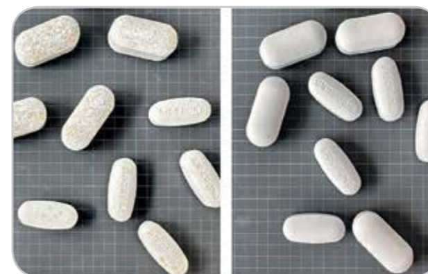
Рисунок 4. Сравнение внешнего вида таблеток витамина С без покрытия (слева) и таблеток витамина С, покрытых 4% (по массе) AquaPolish® MS (справа), после теста ускоренной стабильности
